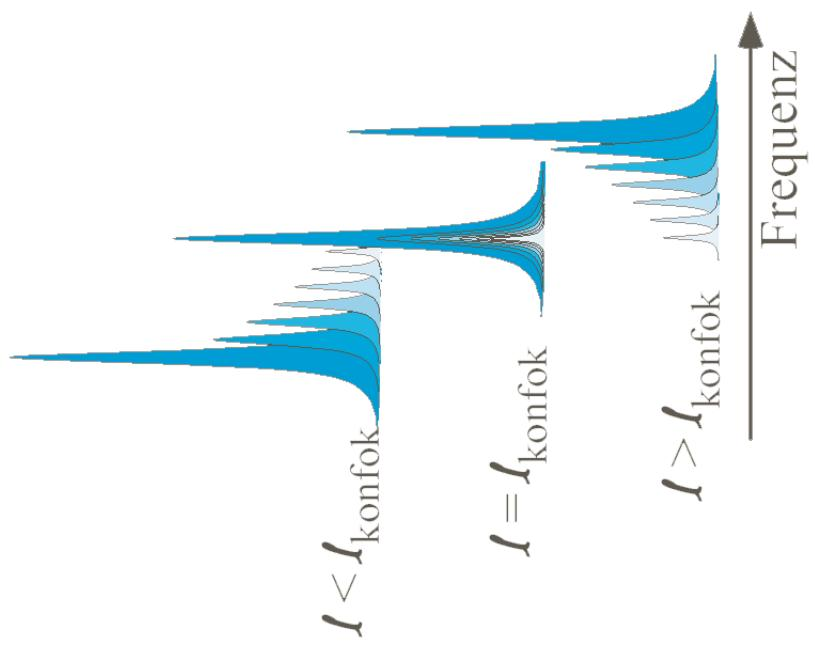
Abbildung 9: Spektrum nahezu konfokaler Resonatoren
